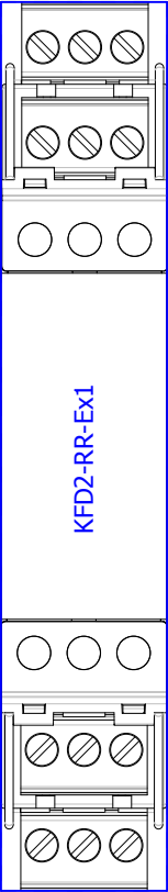
P+F\K-System\KFD2-RR-Ex1.ema Artikelplatzierung Variante A Version 01/2011 Repeater für Temperaturmessfühler, 1-kanalige Trennbarriere
