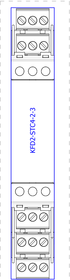
P+F\K-System\KFD2-STC4-2-3.ema Artikelplatzierung Variante A Version 01/2011 SMART-Transmitterspeisegerät, 2-kanaliger Signaltrenner
