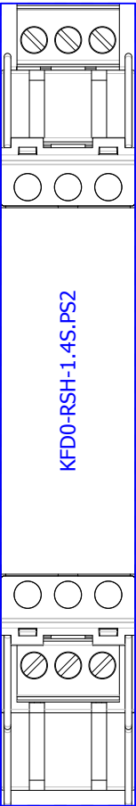
P+F\K-System\KFD0-RSH-1.4S.PS2.ema Artikelplatzierung Variante A Version 01/2011 Relaisbaustein, 1-kanaliger Signaltrenner
